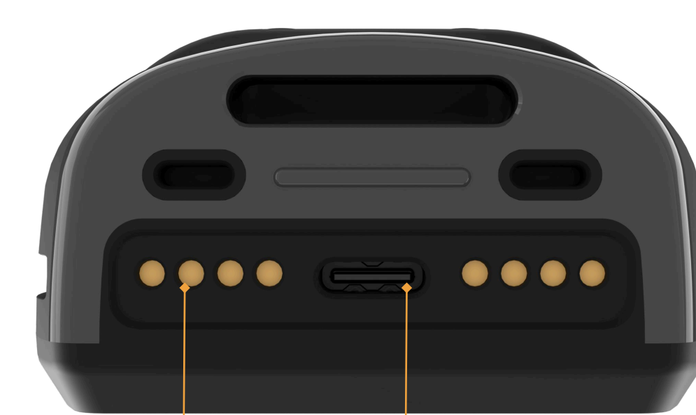
Pin контакты для крепления USB Type-C
